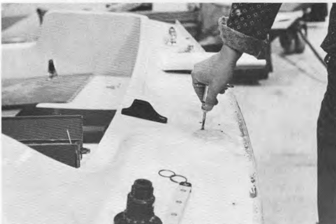
Bild 5 Gängning av skruvhål för vinsch (vinschen isärtagen)
