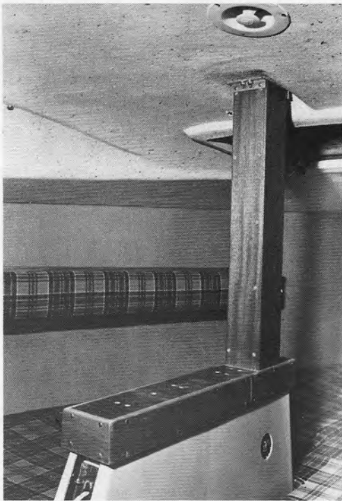
Bild 17 Maststötta och inklädnad av költrumma
