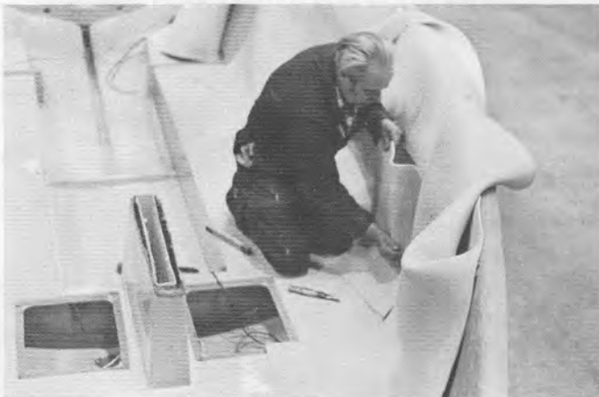
Bild.7 Uppsättning av skrovbeklädnad
