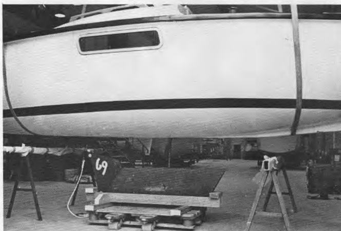
Bild 21 Skrovet sänks ned över kölen
