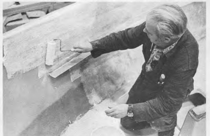
Bild 6 Påläggning av lim för skrovbeklädnad
