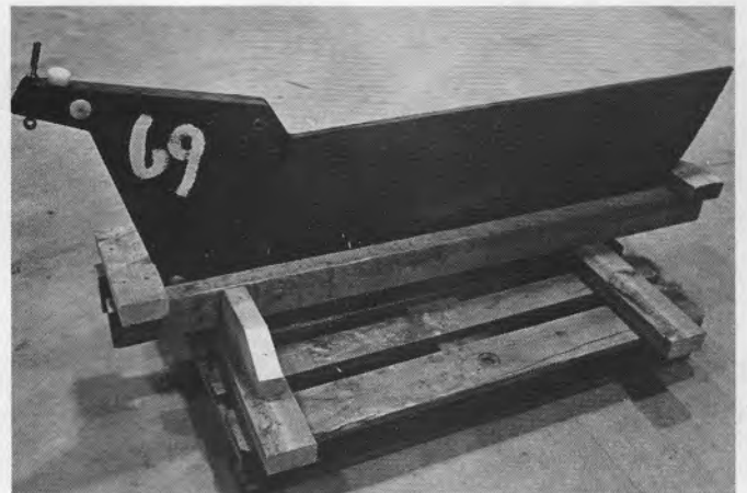
Bild 20 Kölen placerad i "monteringsvagg"
