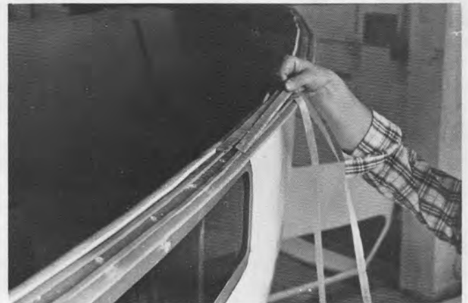
Bild 14 En sträng tätningsmedel på var sida om skruvhålen
