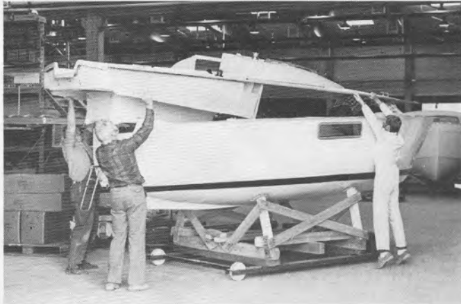
Bild 11 Påläggnig av däck
