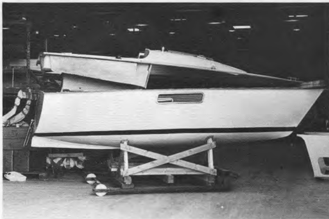
Bild 13 Däcket upplyft för applicering av tätningsmedel
